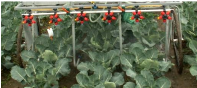
Fig. 4: Utilizzo combinato di barre di trattamento e canne sospese (droplegs) con un apparecchio per piccole superfici su una coltura una coltura di broccoletti.
