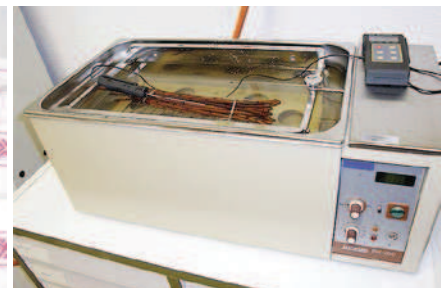
Abb. 2: Wasserbad (50 °C); am Schüttelgestell befestigter Reiserbund.
