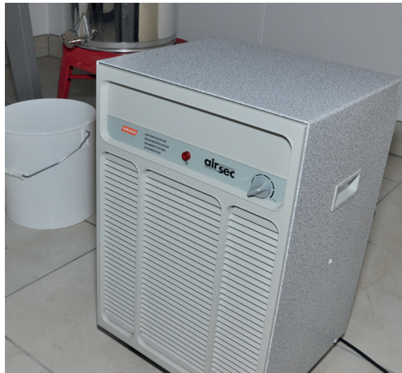
Bild 6: Mit einem Luftentfeuchter kann die Luftfeuchtigkeit im Schleuderraum tief gehalten werden.
