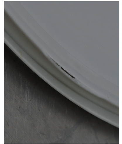
Bild 7: Bei undichten Behältern zieht der Honig Wasser aus der Umgebungsluft an.
