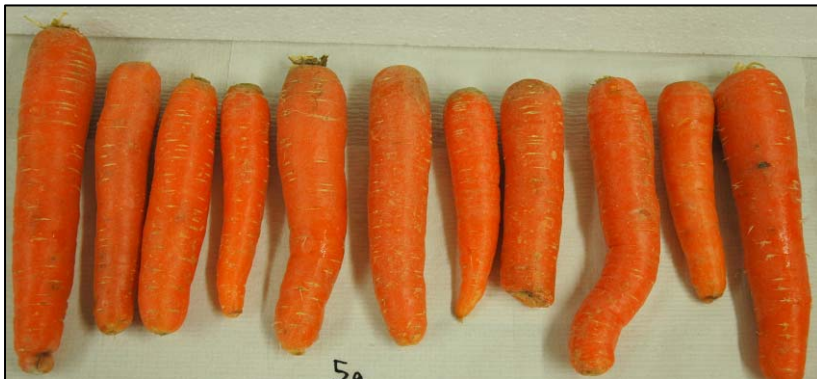
Abb. 24 b): Karotten aus dem Praxisversuch im Frühjahr 2007 mit zusätzlichem, abschließendem Spülschritt mit Frischwasser bei einem Wasserdruck von 20 bar und vier Düsen aus
