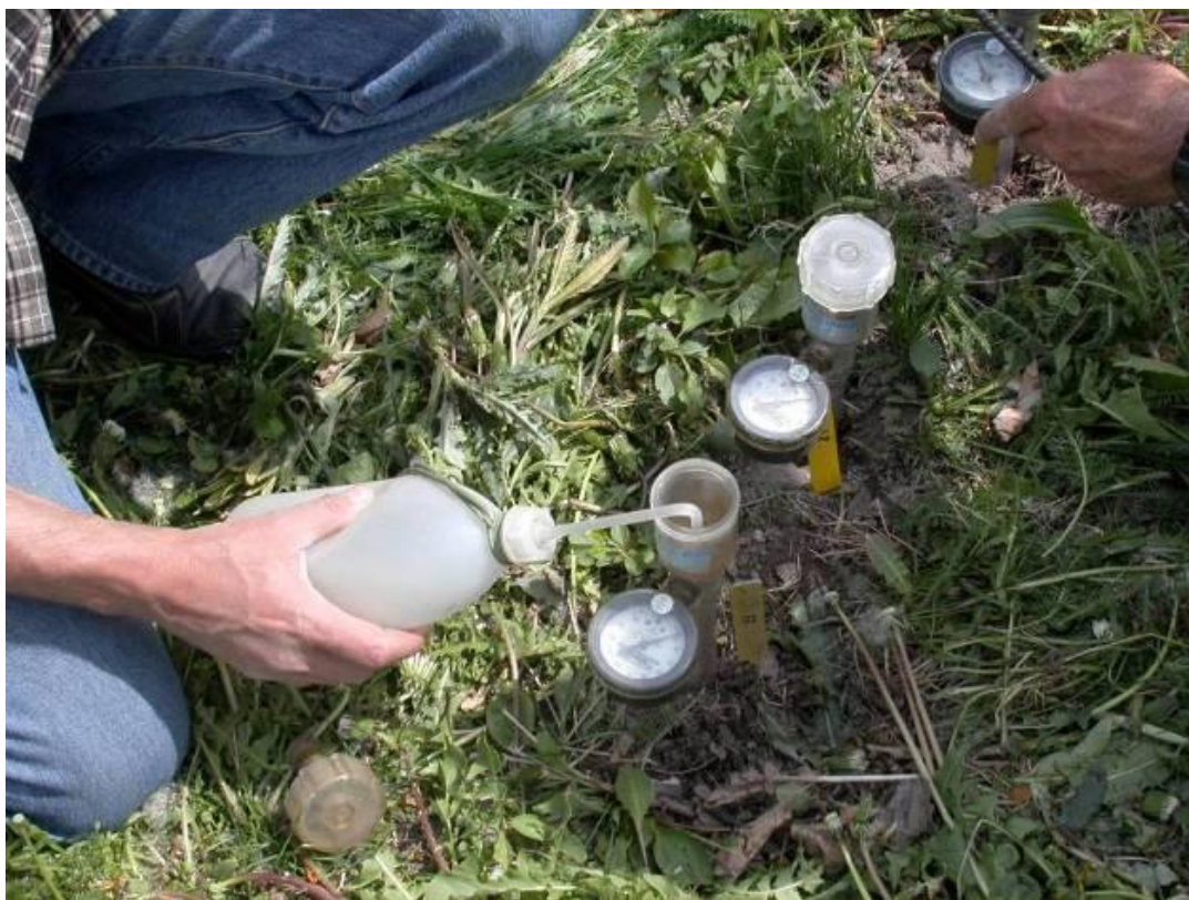
Figure 14: Mise en place et remplissage des tensiomètres
