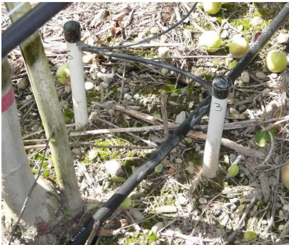
Figure 15: L'une des 3 paires de sondes Watermark® formant un ensemble conçu pour gérer l'irrigation d'une parcelle. La distance au goutteur est ici de 30 cm et les profondeurs sont de 30 et 60 cm
