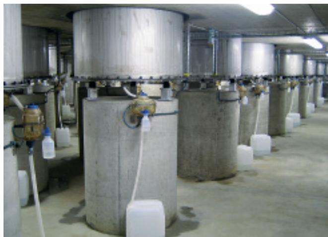
Installation vue de dessous. Les lysimètres sont placés sur des socles en béton. L'eau d'infiltration est recueillie dans un bidon et ses teneurs en nitrates et en autres éléments fertilisants sont analysées.
