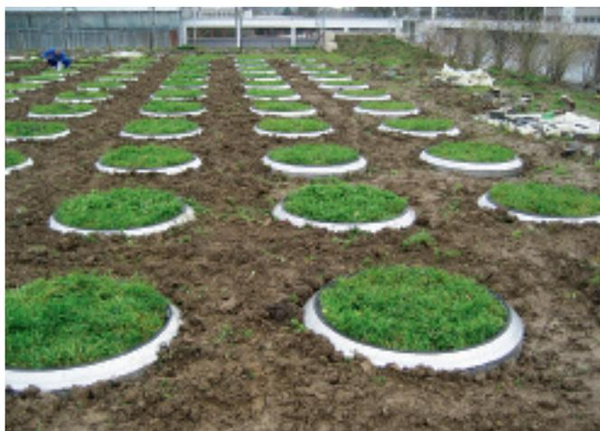
Installation achevée vue de l'extérieur. En surface, les lysimètres sont exposés aux conditions météorologiques. Les chercheurs y mettront en place des cultures et appliqueront différentes méthodes culturales.
