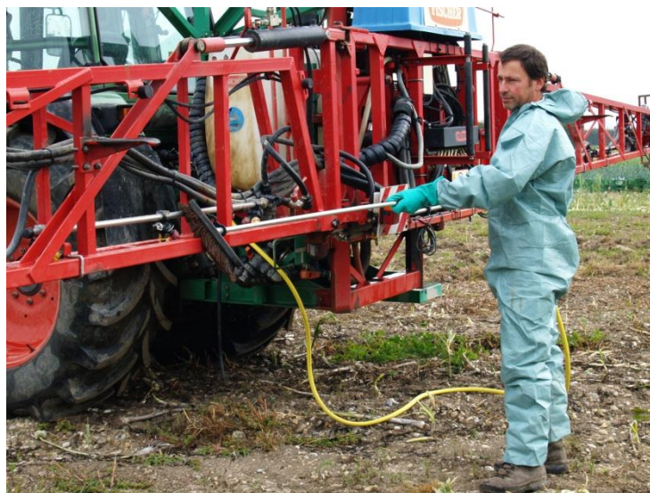
Abb. 1: Grobreinigung des Spritzgerätes innen und aussen mit Spülwasser aus dem Frischwassertank auf einer Feldfläche ohne oberflächlichen Abfluss (Foto ACW).
