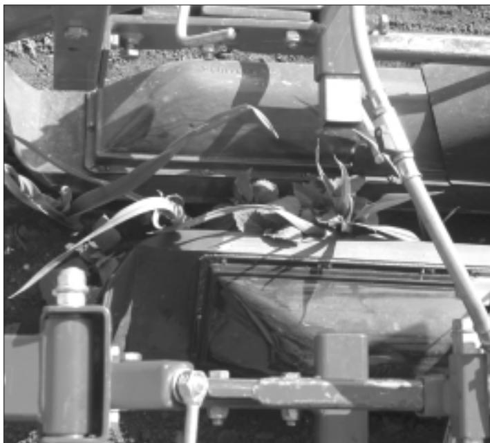
Les poireaux et les adventices passent entre les deux brûleurs; le rayonnement infrarouge agit sur les feuilles des adventices. (Photos: FAW)
