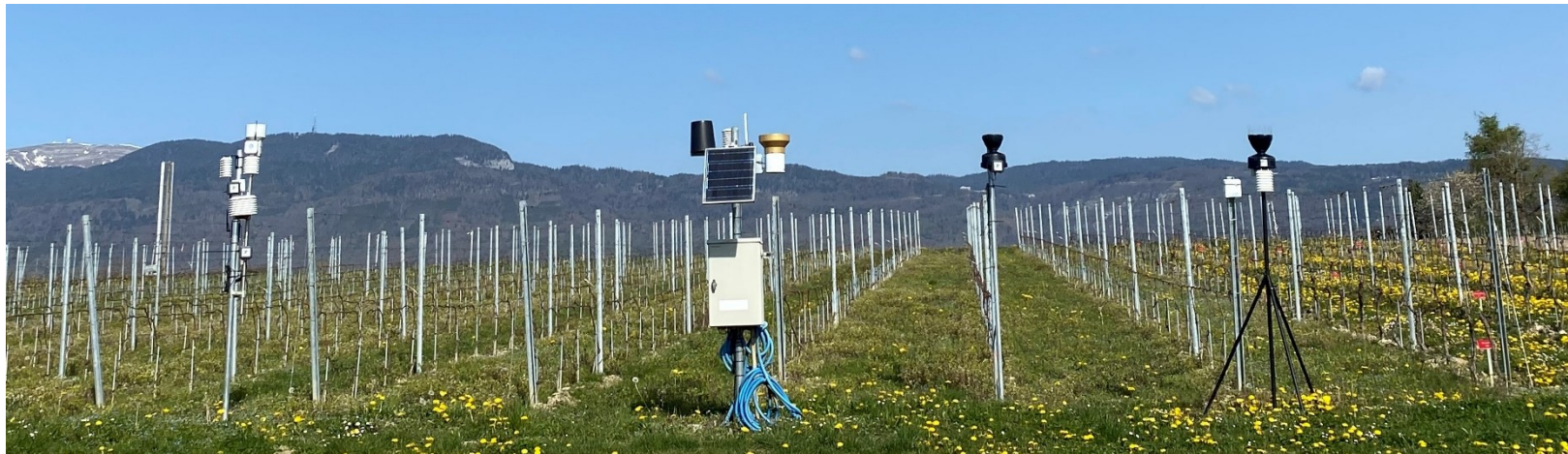
Versuchsaufbau zum Vergleich von Wetterstationen bei Agroscope in Changins
