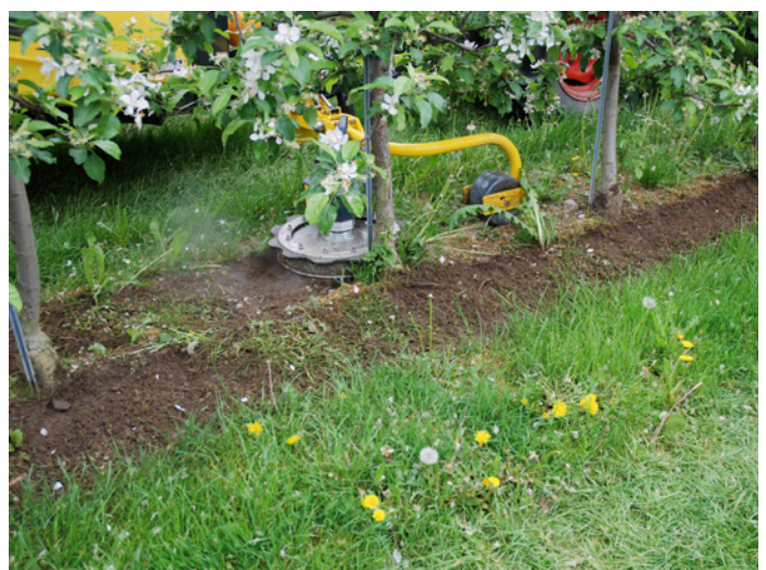
Abb. 5: Die Wirkung beschränkt sich beim Grasskiller auf die Arbeitsbreite des Geräts. Ein weiterer Nachteil ist die mangelnde Erfassung von stammnahen Unkräutern und Stockausschlägen.
