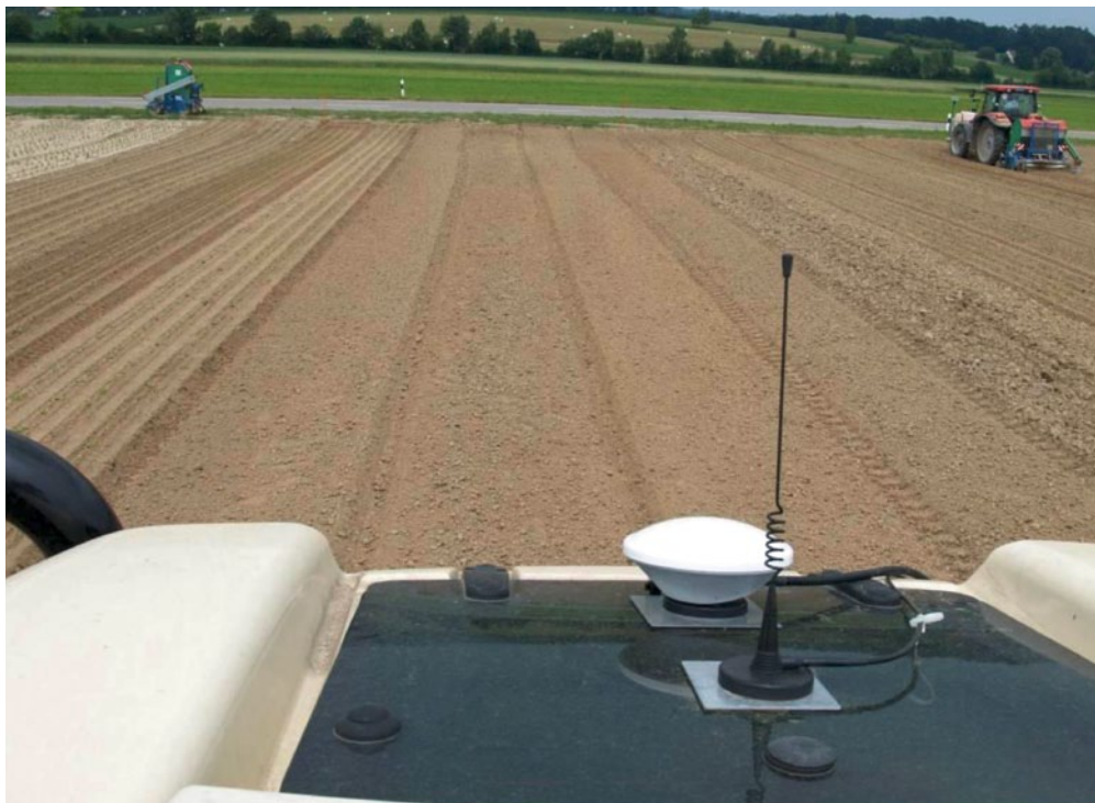
Figure 3 | Utilisation d'une fraise rotative équipée d'un GPS – Pilotage dans une culture maraîchère. (photo: ACW)
