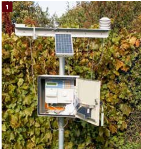
Abb. 1 und 2: Im Gegensatz zu den aktuellen Wetterstationen, die ihre Daten in Echtzeit über das Mobilfunknetz übermitteln (l.), lieferten die frühen Stationen lediglich gedruckte Datenausgaben auf Papier. Für die Blattnässemessung wurde ein Thermohygrograph der Firma Lufft (r.) verwendet. (© Gottfried Bleyer, WBI Freiburg)
