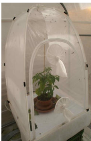
Figure 9: Cage d'élevage de punaises marbrées placée en serre, pour les tests de ponte (photo: Agroscope).
