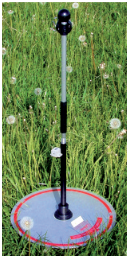
Fig. 1. Herbomètre utilisé pour les mesures de la hauteur de l'herbe (modèle néo-zélandais Jenquip® «Plate Pasture Meter»).
