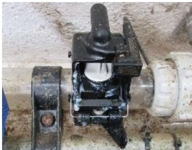
Fig. 12: Robinet à lait avec résidus de lait
