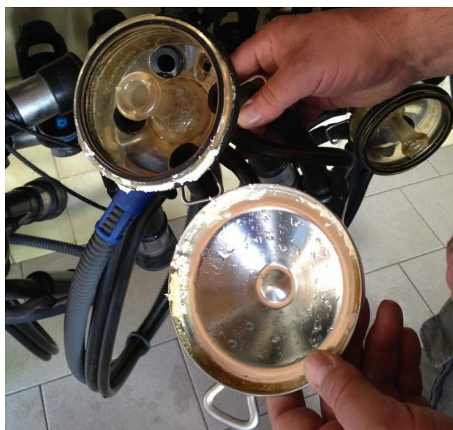
Fig. 3: Dépôts dans une griffe
