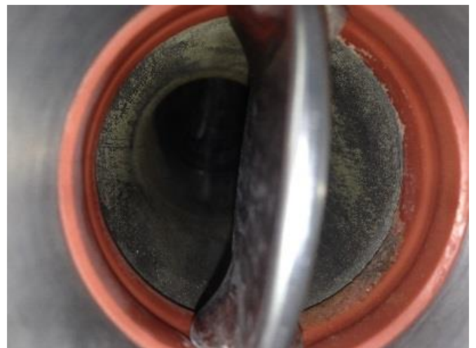
Fig. 9: Dépôts à la sortie de la vanne d'un tank à lait
