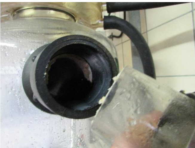
Abb. 6: Ablagerungen in Gummi-Dichtung der Endeinheit
