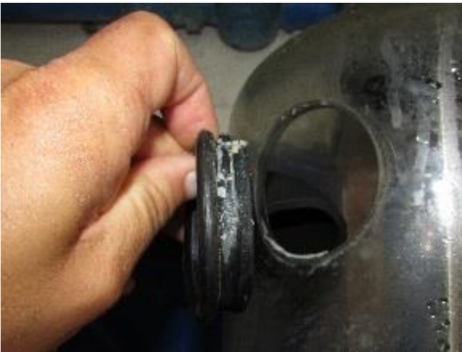
Abb. 4: Gummi-Stopfen der Endeinheit mit Ablagerungen
