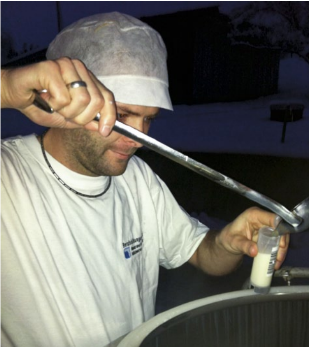
Abb. 2 | Manuelle Probenahme für die Milchprüfung.
