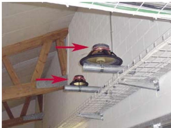
Abb. 1: Lautsprechersysteme zur Erzeugung definierter Lärm- und Körperschallintensitäten. (Foto: ART)
