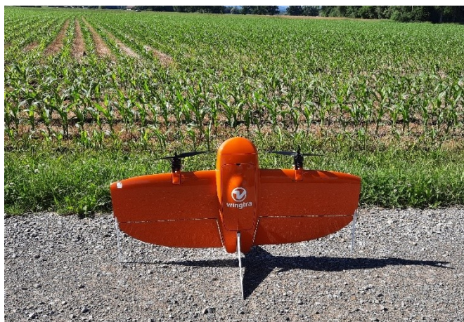
Foto 1: la grande 'wingtra' decolla in verticale. In volo la velocità minima è di 50 km/h e l'altezza di volo era di 60 m (foto: Agroscope).
