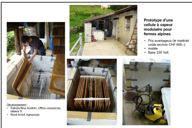
Fig. 4 : Cellule à vapeur modulaire pour les Alpes et les petites entreprises
