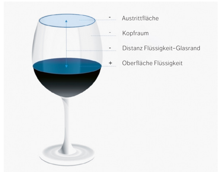
Abb. 3: Die Form und Funktion eines Weinglases werden im Wesentlichen durch vier Parameter bestimmt. +/- = Hypothetische Korrelation mit der Aromakonzentration im Glas. (© Agroscope)
