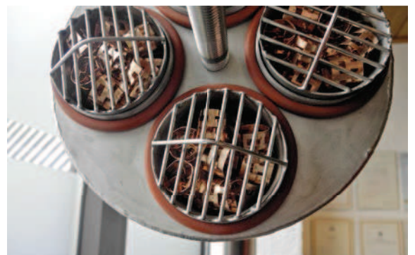
Abb. 1: Der Katalysator lässt sich einfach ausbauen und reinigen.
