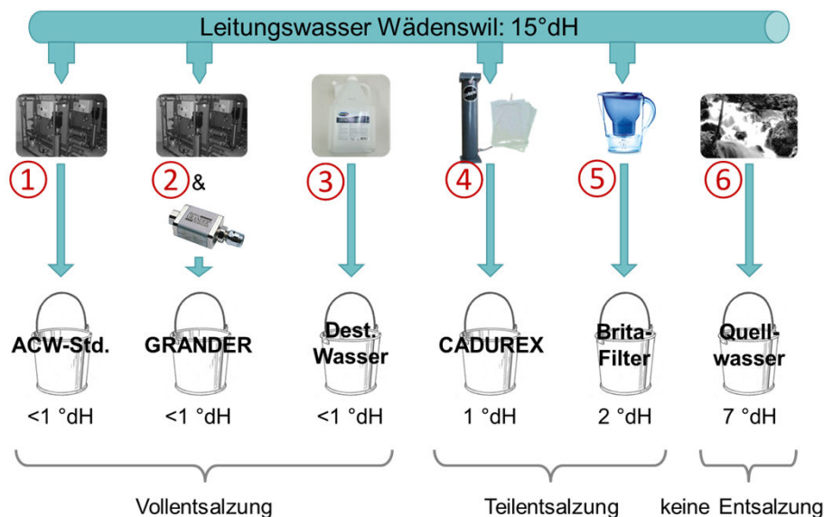
Abbildung 1. Übersicht der Wasservorbehandlung
