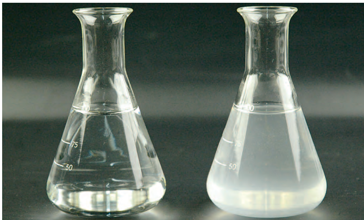
Abb. 1: Trübungen in einem Destillat (rechts) durch Herabsetzen mit hartem Verschnittwasser.
