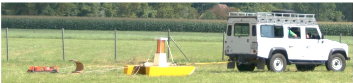
Schleppgeophysik in der Anwendung. Elektromagnetik und Gammaskpektroskopie.
