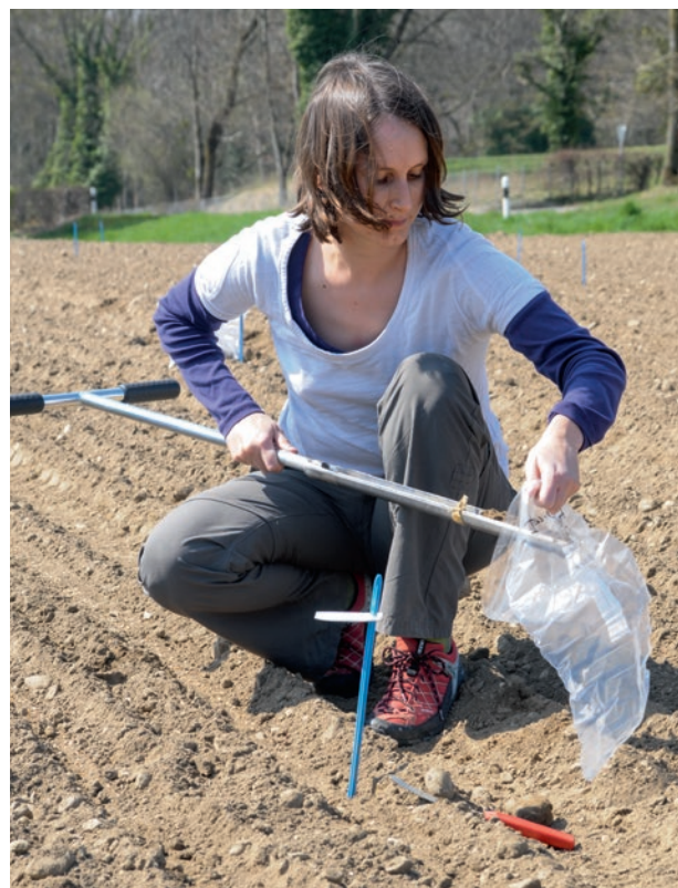
Figure 4 | Echantillonnage de sol avec une tarière dans un champ de blé à Prangins (VD).
