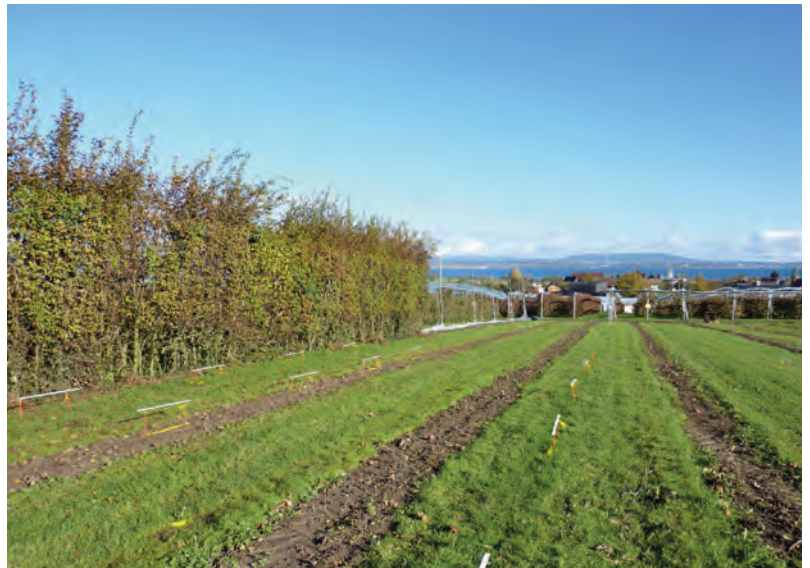
Abb. 1: Versuchspartelle Güttingen mit Hainbuchenhecke als Driftschutz (im Vordergrund) und Messkollektoren in unterschiedlicher Distanz zur Applikationsfläche.
