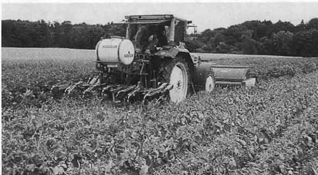
Abb. 1. Mit der Kombination Krautschläger und Bandspritze kann der Herbizidverbrauch um 60% reduziert werden. Rechts: Durch Krautschlagen und -ziehen lässt sich an günstigen Standorten auch in einem Durchgang eine ausreichende mechanische Krautvernichtung erzielen.
