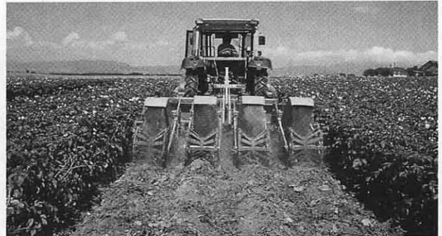
Abb. 1. Mit der Kombination Krautschläger und Bandspritze kann der Herbizidverbrauch um 60% reduziert werden. Rechts: Durch Krautschlagen und -ziehen lässt sich an günstigen Standorten auch in einem Durchgang eine ausreichende mechanische Krautvernichtung erzielen.
