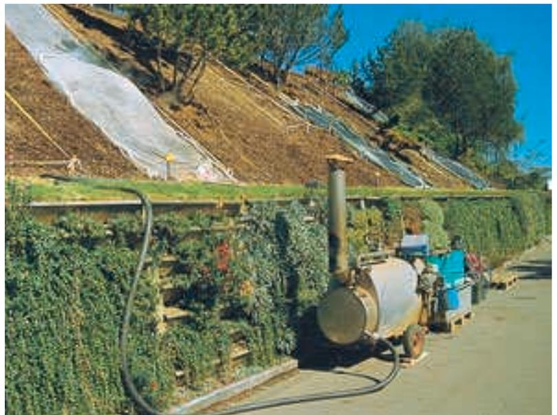
Abb. 3: Dampfgerät (Buser, Dampfkessel- und Apparatebau, Olten) wie es in Gärtnereien zum Dämpfen von Böden in Gewächshäusern oder Treibbeeten üblich ist.
