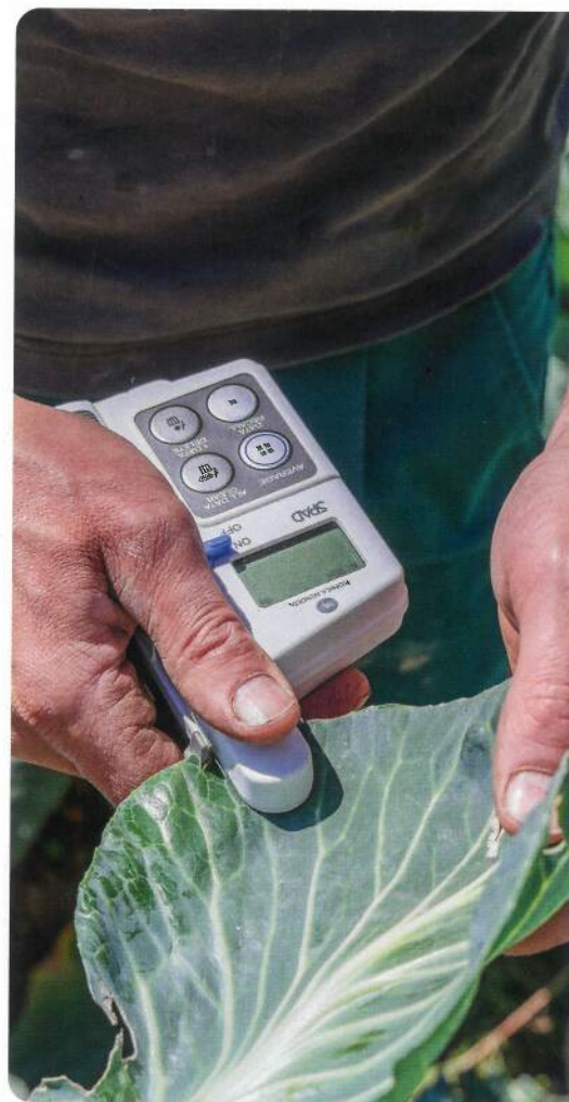
Mesure de chlorophylle dans la feuille avec un appareil SPAD.
