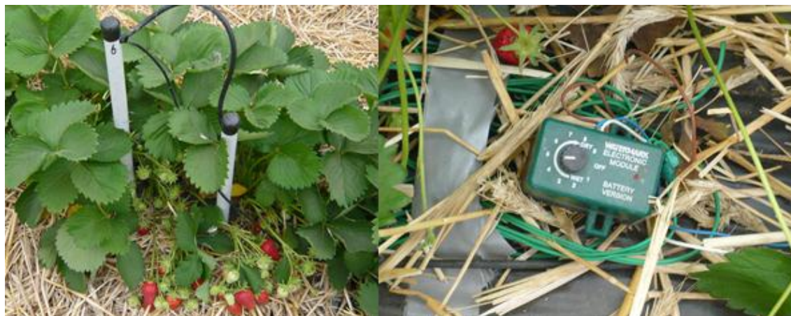
Fig.1: Gestion automatisée de l'irrigation basée sur des sondes Watermark® et pilotée par le système WEM (Watermark Electronic Module).
