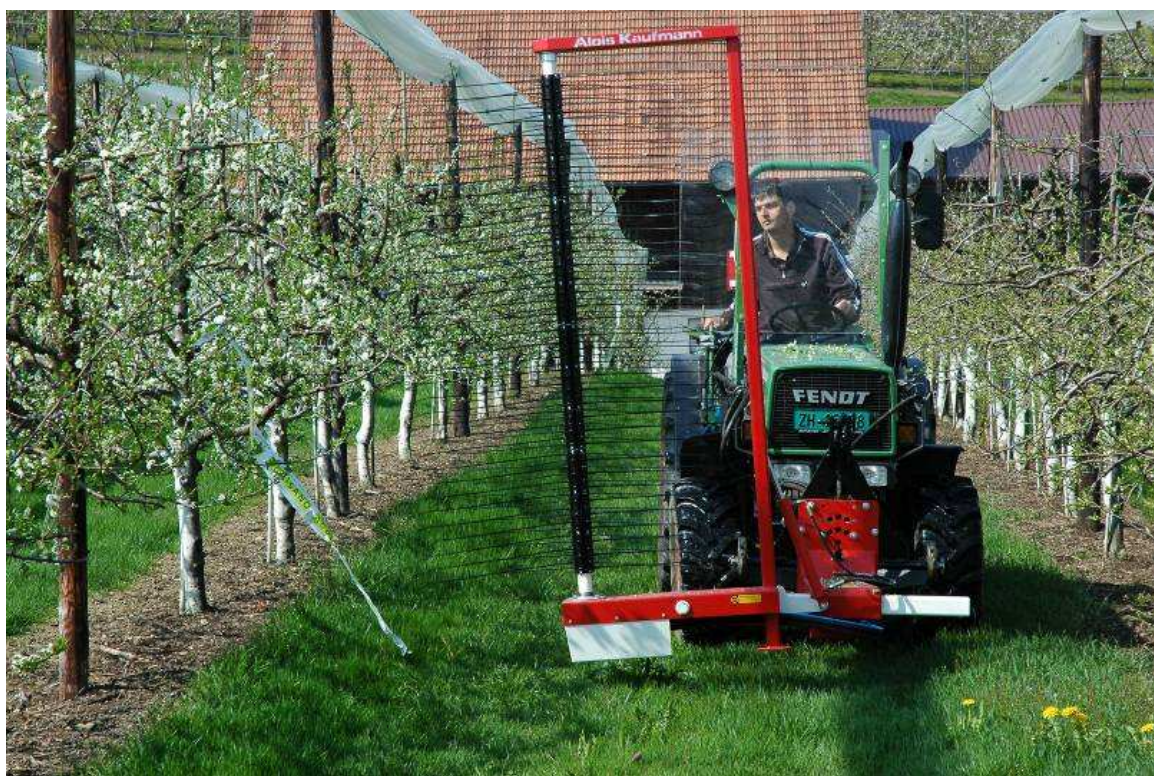
Abb. 1: Das Fadengerät „Tree-Darwin“ kann auch zur Ausdünnung im Zwetschgenanbau eingesetzt werden. Voraussetzung sind aber schmale Baumformen.
