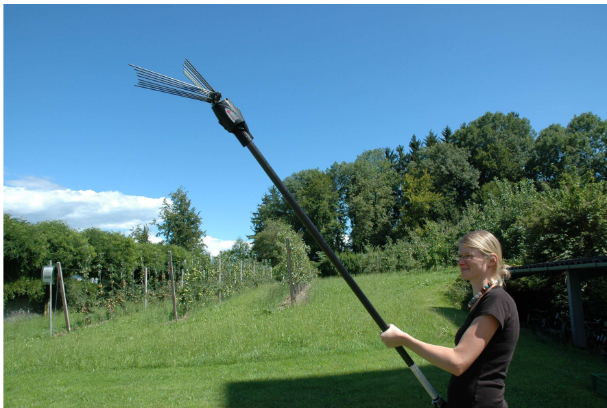
Abb. 2: Der Olivenschüttler „Electro'liv“ kann kurz vor der Handaussdünnung eingesetzt werden. Mit den rotierenden Stäben werden die überzähligen Früchte abgeschlagen. Die verbleibenden Früchte weisen teilweise Schäden durch die Stäbe auf.
