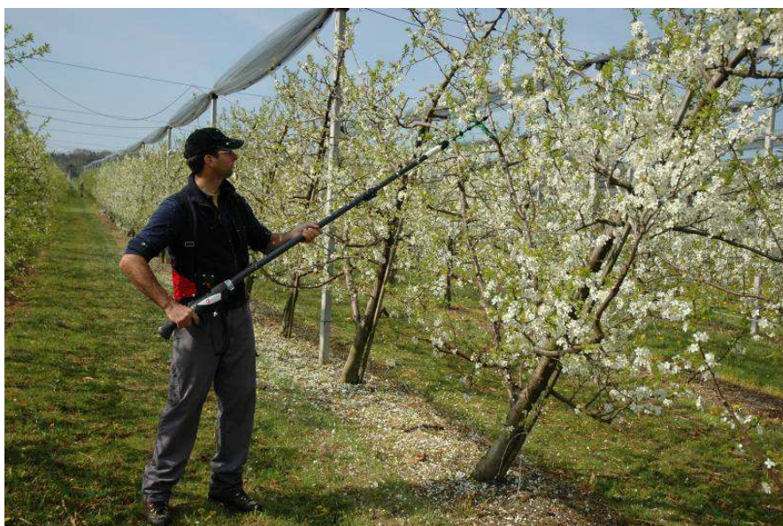
Abb. 3: Das handgeführte, batteriebetriebene Aussdünngerät „Electro'flor“ wird zur Blütenaussdünnung eingesetzt. Die Fäden der rotierenden Spindel reduzieren den Blütenansatz. Dadurch wird der Aufwand für die Handaussdünnung verringert
