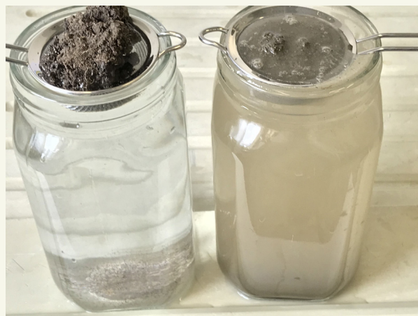
Figure 1. Stabilité des agrégats du sol de deux sols limoneux-sableux avec 7 % de MOS (à gauche) et 2 % de MOS (à droite).
