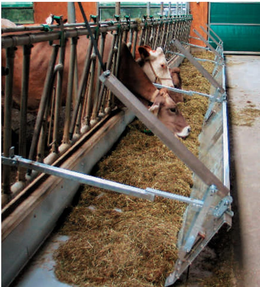
Fig. 4: Lorsqu'il n'y a plus que quelques restes de fourrage, le bord de crèche relevable équipé d'un mécanisme de bascule peut repousser le fourrage sur 10–20 cm.
