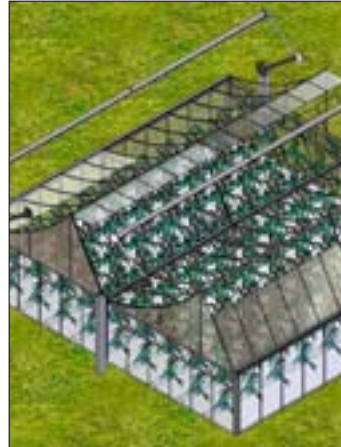
Modèle d'une serre produisant de l'énergie en bloquant les rayons infrarouges proches (NIR) avec des filtres. (Source: Piet Sonneveld)
