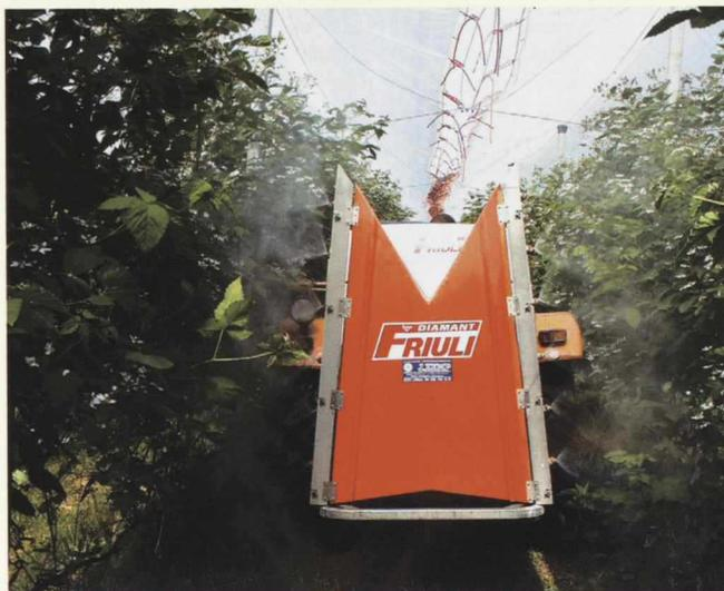
Fig. 8. La largeur et le débit d'air de ce turbodiffuseur ne sont pas adaptés à la culture de mûres à traiter. Le débit d'air trop élevé fait bouger les feuilles.
