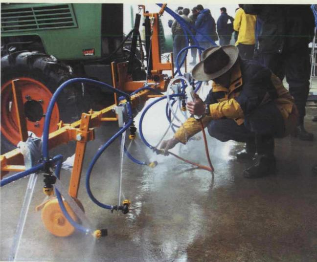
Fig. 4. Mesure du débit des buses à l'aide d'un débitmètre.
