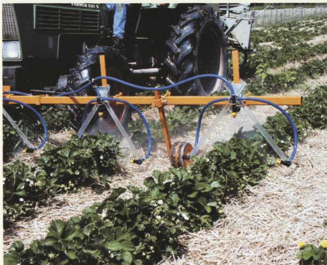
Fig. 6. Disposition correcte des buses sur une barre de traitement: une buse traite le dessus de la culture, deux autres buses, légèrement inclinées, traitent les côtés.
