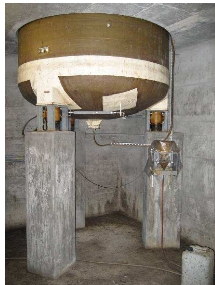
Lysimeterkeller mit Kippwaage für Sickerwassermessung.
