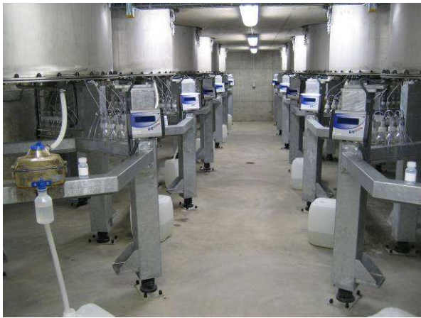
Lysimeterkeller mit wägbaren Lysimetern, Kippwaagen für Sickerwassermessung, Probenentnahmeflaschen und Messsonden.
