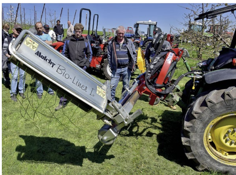
Abb. 2: Mulchy Bio Liner I: Fadengerät der Firma Silent.
