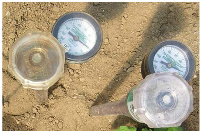
Fig. 6: Les tensiomètres permettent de connaître le degré d'humidité du sol et d'irriguer en conséquence. .
