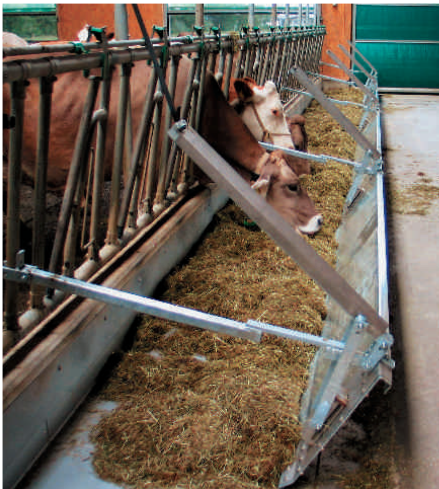
Abb. 4: Wenn nur noch eine Restmenge Futter vorhanden ist, kann der aufziehbare Krippenrand mit Anschlebung das Futter um 10–20 cm nachschieben.
