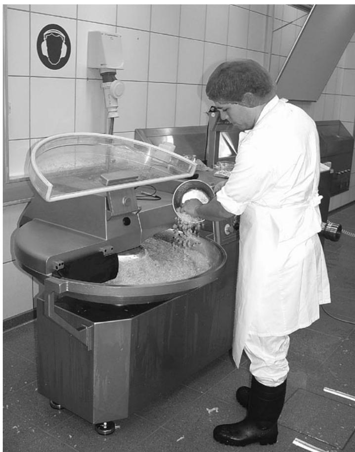
Abb. 1. Herstellung der Lyoner-Brätmasse im Blitz.
