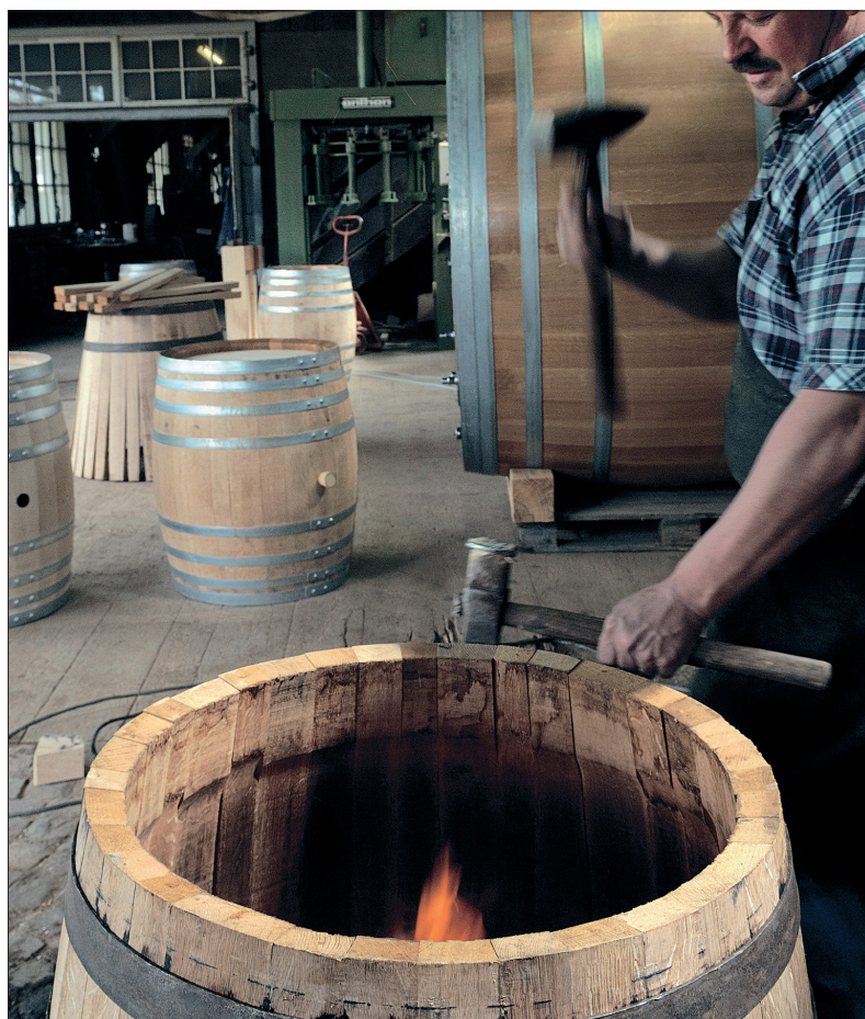
Barrique-Herstellung in der Schweiz aus einheimischer Eiche: «Chauffe».
