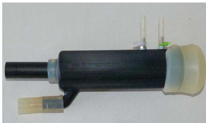
Abbildung 1: Prototyp des neuen Melkbechers im Melklabor des ATB (Foto: Stollberg/Ströbel).
