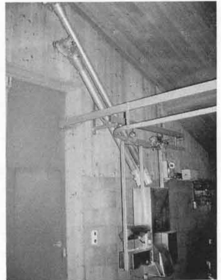
Fig. 4. Comme accessoire, des stations de remplissage automatique sont disponibles. Elles servent à remplir les distributeurs en position d'arrêt ou dans une position de remplissage déterminée. Des vannes actionnées à la main constituent une solution plus simple.
