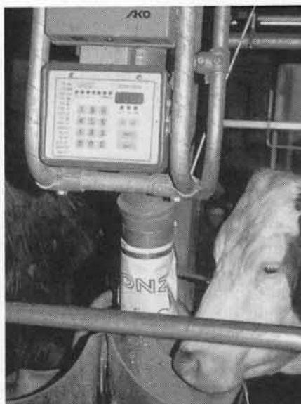
Fig. 6. Cette installation distribue l'aliment directement dans les mangeoires. Le processeur contient le programme d'alimentation.
