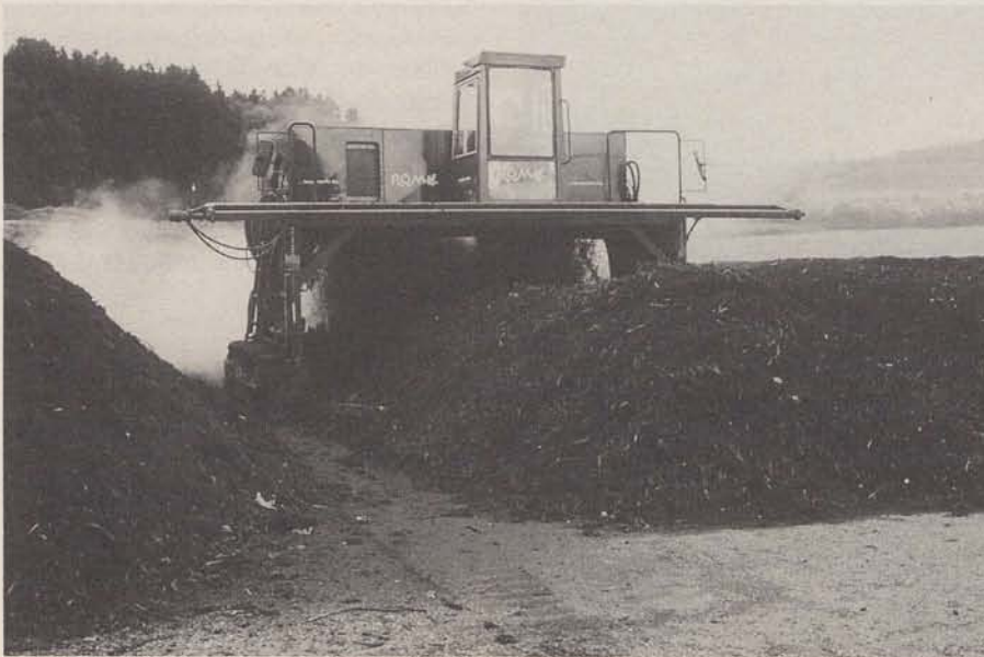
Fig. 7. Machine à retourner le compost automotrice dans une compostière.
