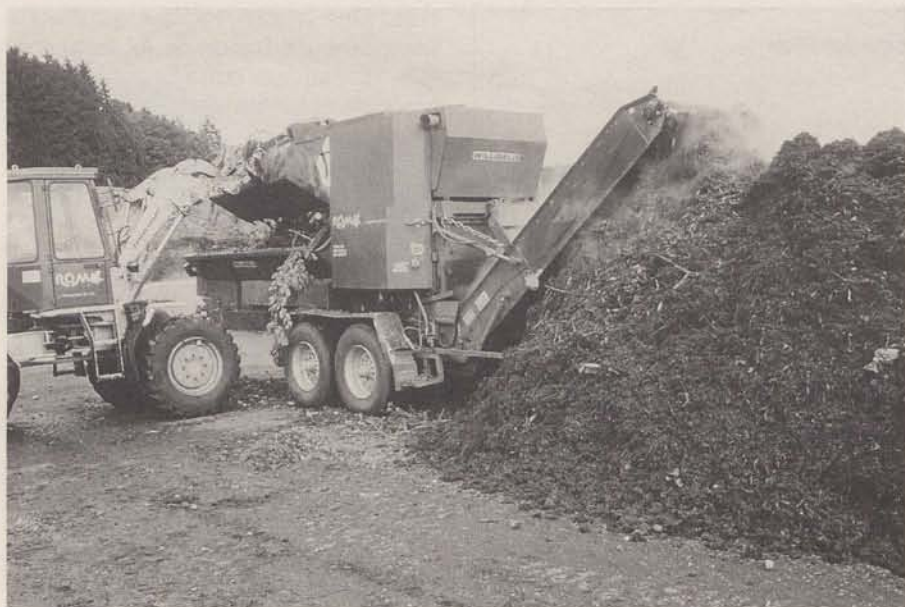
Fig. 3. Broyage des matières premières et mise en place de l'andain en une seule étape.
