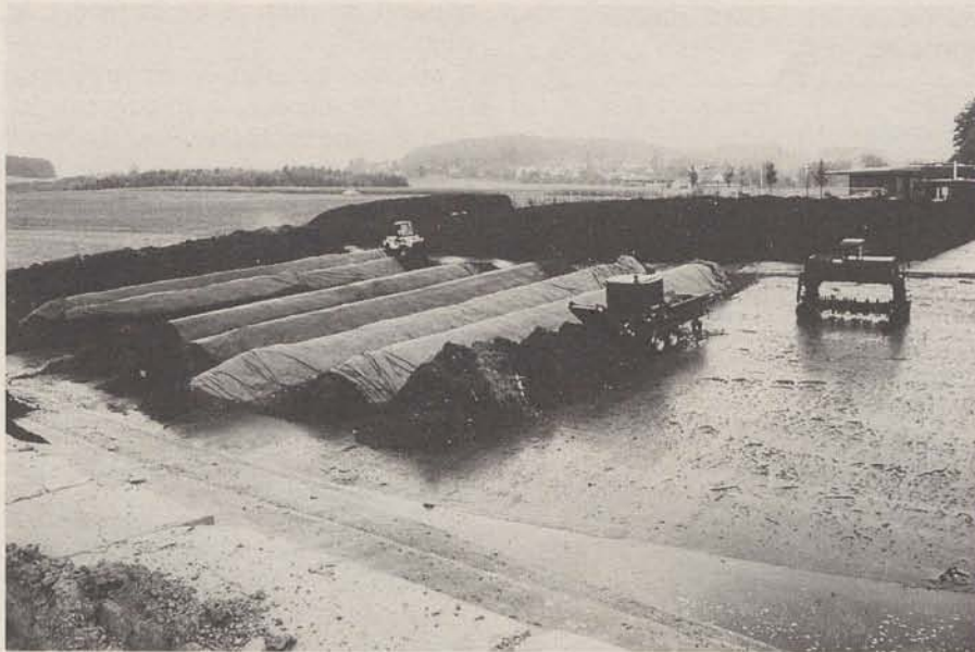
Fig. 13. Compostière. Andain placé sur une surface en dur, couvert d'un film de protection, alimentation du broyeur (photo centrale) avec chargeuse à pneus (à gauche), brassage de l'andain avec appareil automoteur (à droite).
