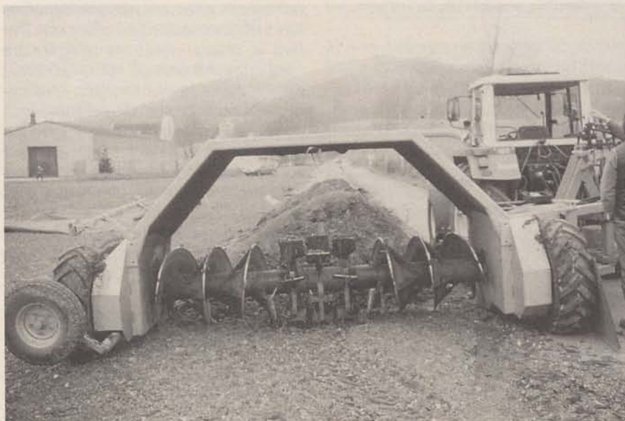
Fig. 6. Machine à retourner le compost tractée en fonction pour le compostage en bord de champs, le long d'un chemin en dur (piste cyclable).
