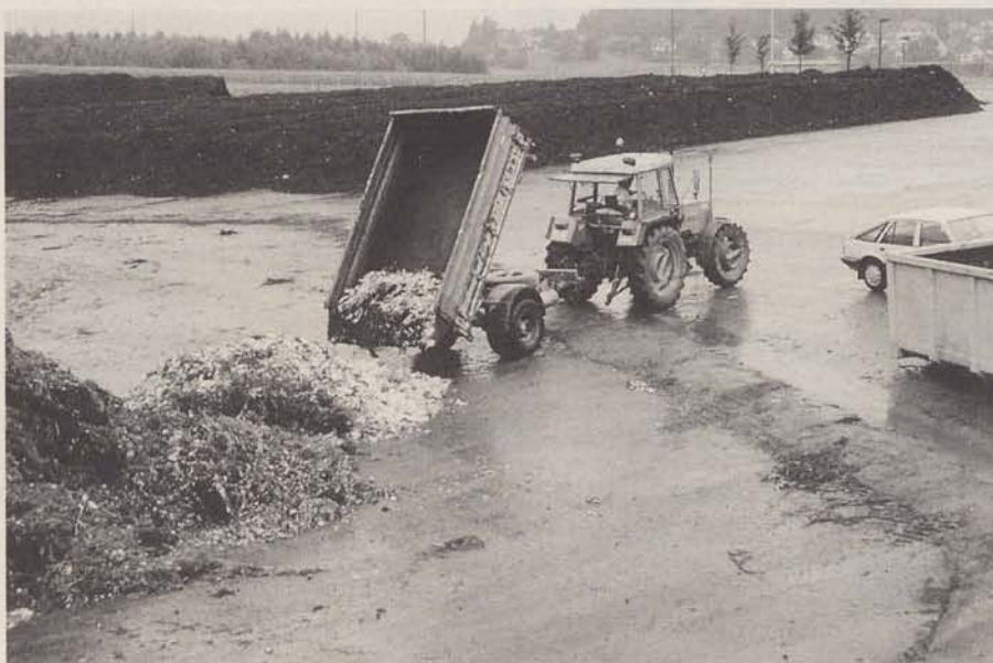
Fig. 2. Avec le système de livraison, les déchets sont apportés directement à la compostière. Il est recommandé d'effectuer un contrôle visuel des matériaux livrés avant le déchargement.
