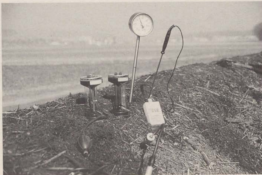
Fig. 10. Instruments de mesure pour contrôler le processus de compostage. A gauche, deux instruments servant à mesurer la teneur en CO 2 de l'air dans l'andain, à droite, thermomètres.
