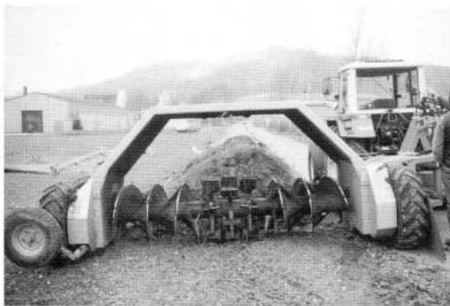
Abb. 6. Gezogenes Mietenumsetzgerät im Einsatz bei der Feldrandkompostierung entlang eines befestigten Weges (Radweg).
