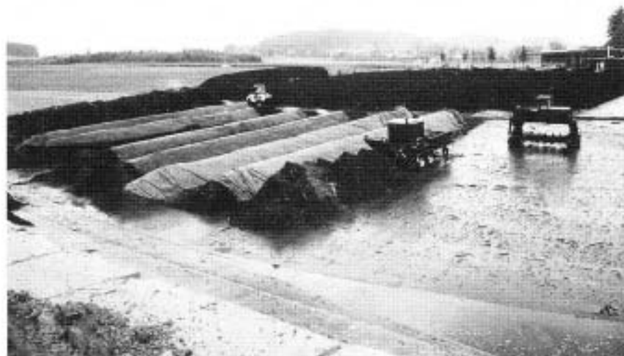
Abb. 13. Platzkompostierung. Miete auf befestigtem Untergrund und Abdeckung mit Kompostvlies, Beschickung des Shredders (Bildmitte) mit Radlader (links), Umsetzen der Mieten mit selbstfahrendem Gerät (rechts).
