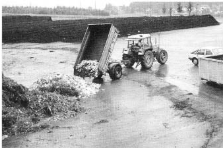
Abb. 2. Beim Bringsystem werden die Abfälle auf den Kompostierplatz angeliefert. Eine Sichtkontrolle des angelieferten Materials ist vor dem Abladen empfehlenswert.
