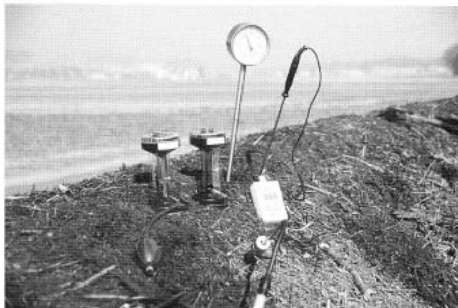
Abb. 10. Messgeräte zur Überwachung des Kompostierungsprozesses. Links zwei Geräte zur Messung des CO 2 -Gehalts in der Mietenluft, rechts Temperaturmessgeräte.
