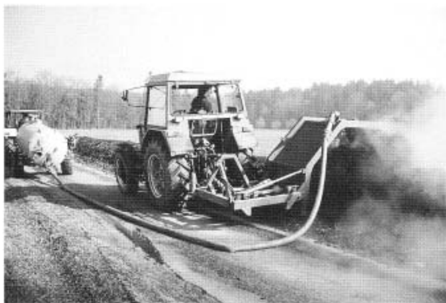
Abb. 11. Befeuchten der Miete während des Umsetzens. Das Wasser kann besser in die Miete eingemischt werden als bei oberflächlicher Bewässerung.
