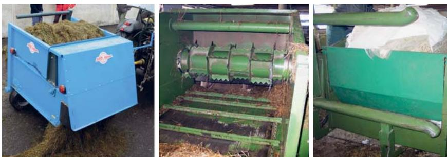
Fig. 10: Dérouleurs de balles fermés: outil tracté (photo de gauche); fond mouvant pour convoyer les balles et rouleau démêleur pour les dérouler (photo du milieu); un tôle supplémentaire permet d'ouvrir les balles d'ensilage de maïs ou encore de distribuer du fourrage en vrac (photo de droite).
