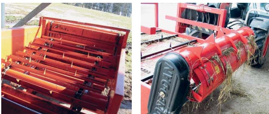
Fig. 9: Possibilités d'ouverture des balles rondes contenant du fourrage coupé en brins grossiers: barre d'enlèvement et fond mouvant à dents (photo de gauche); fond mouvant avec rouleau démêleur simple (photo de droite).
