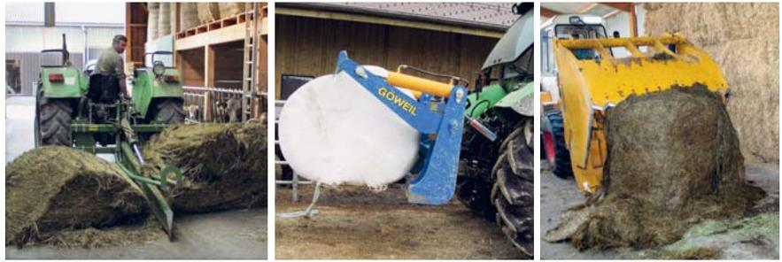
Fig. 6: Trois différents types de systèmes coupe-balles: système avec couteau en forme d'épée (photo de gauche); reprise et transport des balles rondes avec le dispositif à lame (photo du milieu); les fourches à désiler qui possèdent un angle d'ouverture suffisamment grand peuvent couper les balles rondes (photo de droite).
