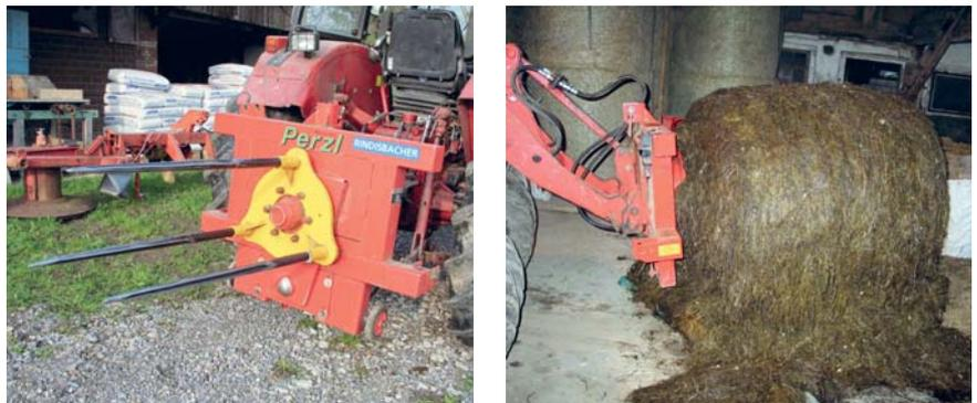
Fig. 7: Dérouleur rotatif à pince monté aux trois points du tracteur (photo de gauche) et au chargeur frontal (photo de droite).
