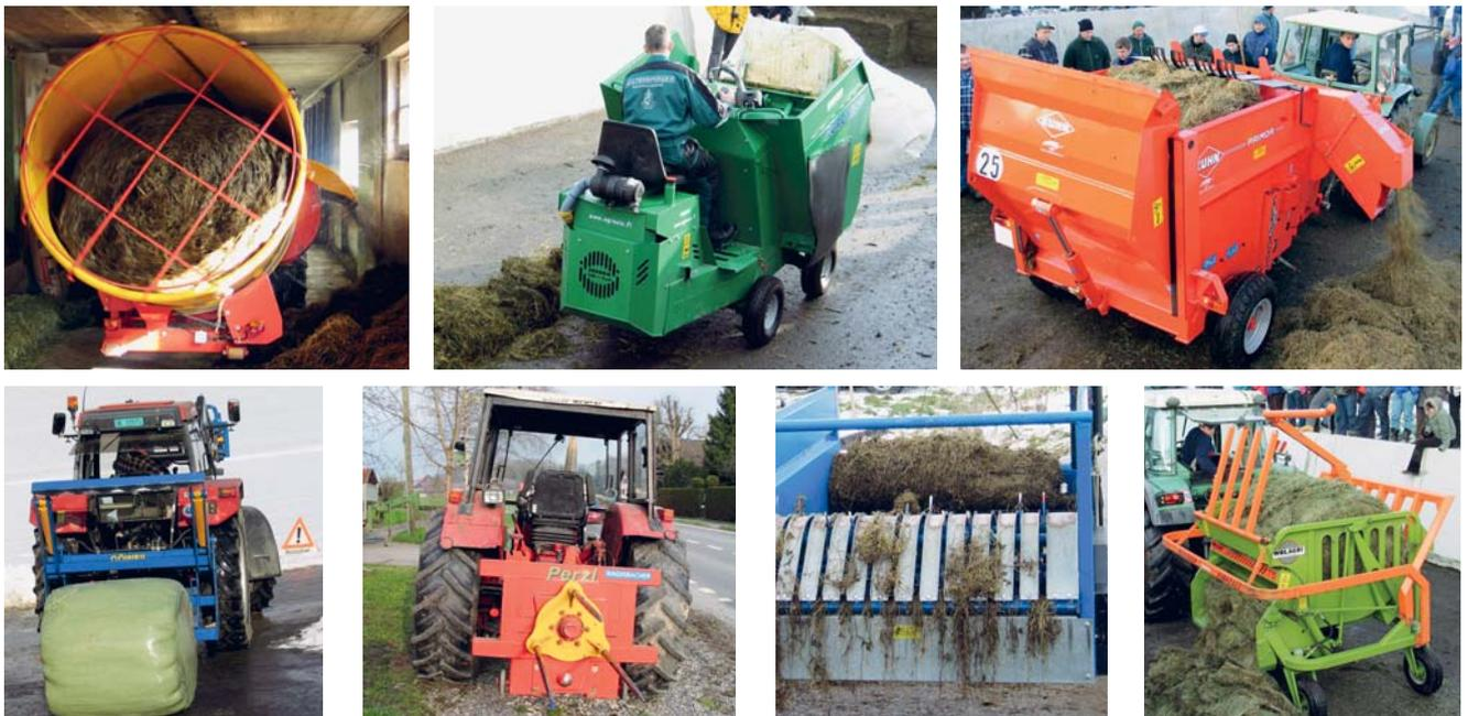
Fig. 1: Différents outils facilitent l'ouverture des balles rondes et la distribution du fourrage. Pour choisir l'outil qui convient, il faut tenir compte de la taille du troupeau, des possibilités et du taux d'utilisation, de la ration de fourrage, du mode de stockage, de la technique d'affouragement en place, des machines de traction et de la place disponible sur l'exploitation.
