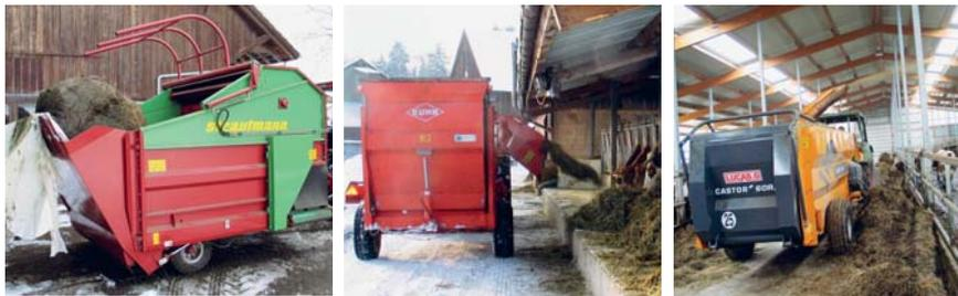
Fig. 11: Remorque distributrice blocs universelle en train de charger une balle ronde par la trappe (photo de gauche); distribution de fourrage avec la remorque (photo du milieu); paillage d'une surface de litière sur plan incliné à l'aide d'un dispositif d'éjection (photo de droite).
