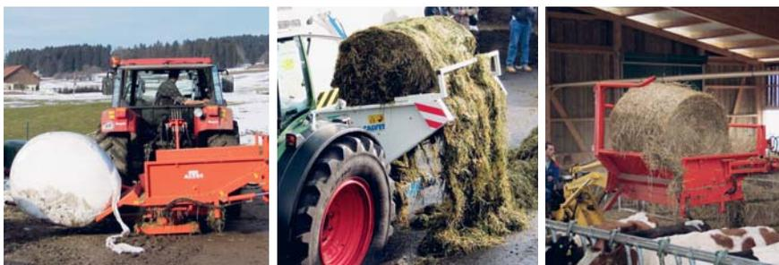
Fig. 8: Dérouleurs de balles ouverts: chargement avec bras spécial (photo de gauche); le déroulement et la distribution des balles d'ensilage avec un outil monté aux trois point exigent un tracteur lourd ayant la capacité de levage nécessaire (photo du milieu); paillage des logettes avec un dérouleur de balles ouvert monté sur le chargeur frontal (photo de droite).
