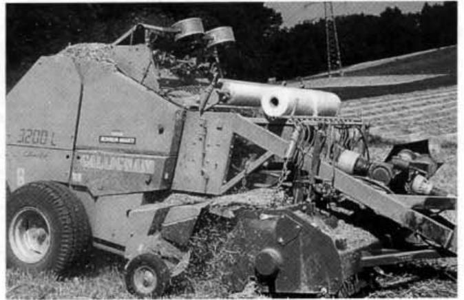
Fig. 2. Les hacheuses portées à l'avant des presses à grosses balles hachent déjà la paille sur la parcelle, ce qui élimine le risque d'incendie et le dégagement de poussière gênante. Le degré de hachage dépend du réglage et de la vitesse d'avancement de la machine.
