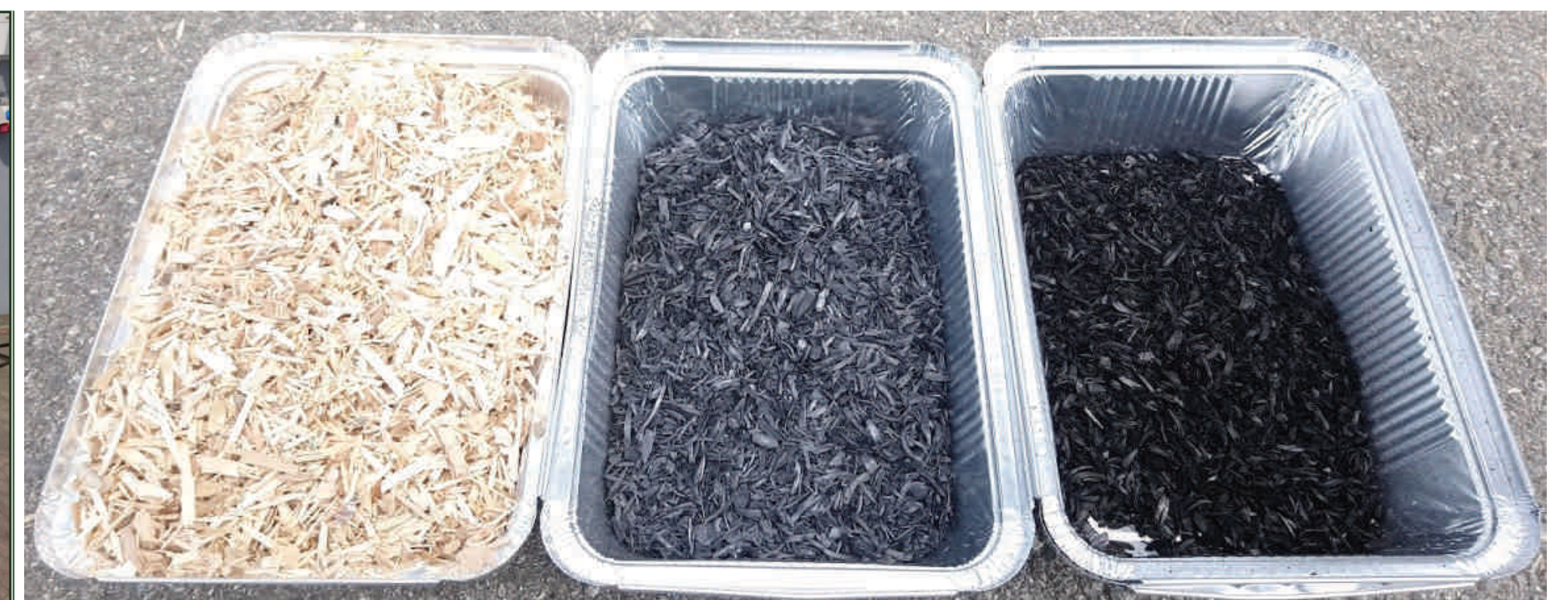
Abb. 2: Altholz, Hochtemperatur-Pflanzkohle (900 °C) und Aktivkohle (Dampfaktivierung, 900 °C)
