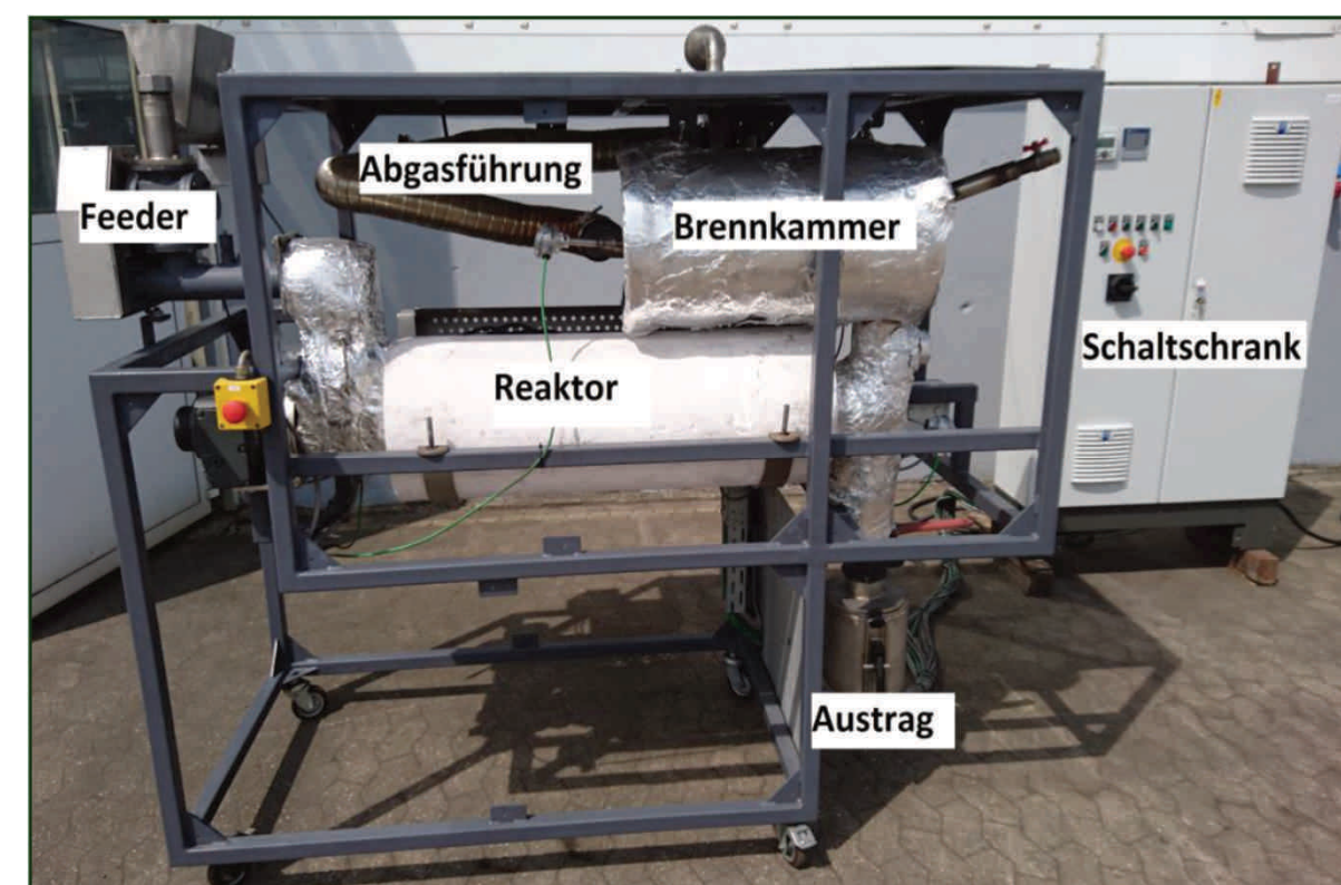
Abb. 1: Pilotanlage «PYREKA». Der Reaktor ist 1 m lang. (Fa. Pyreg)
