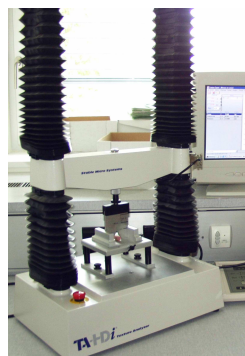
Figure 2: appareil pour mesurer la force de cisaillement
